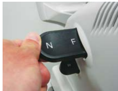
Inserire/estrarre il filtro RF mediante apposito selettore
